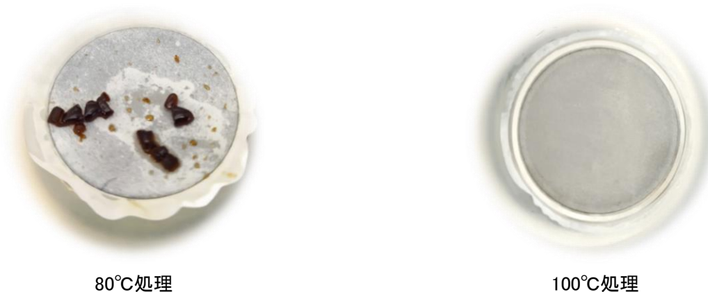
図 7 DBU 類縁体 F を用いて GL200 含有樹脂を 24 時間分解処理した不溶残渣の様子
