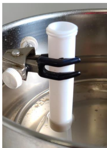
図 2 DBU および DBU 類縁体を用いた処理の様子(左)と用いた CFRP(右)
