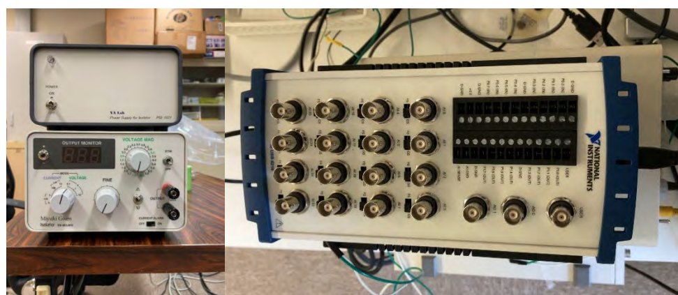
図 12: 左図はアイソレーター(下)と電源供給装置(上)。右図はデジタル-アナログ変換器。
