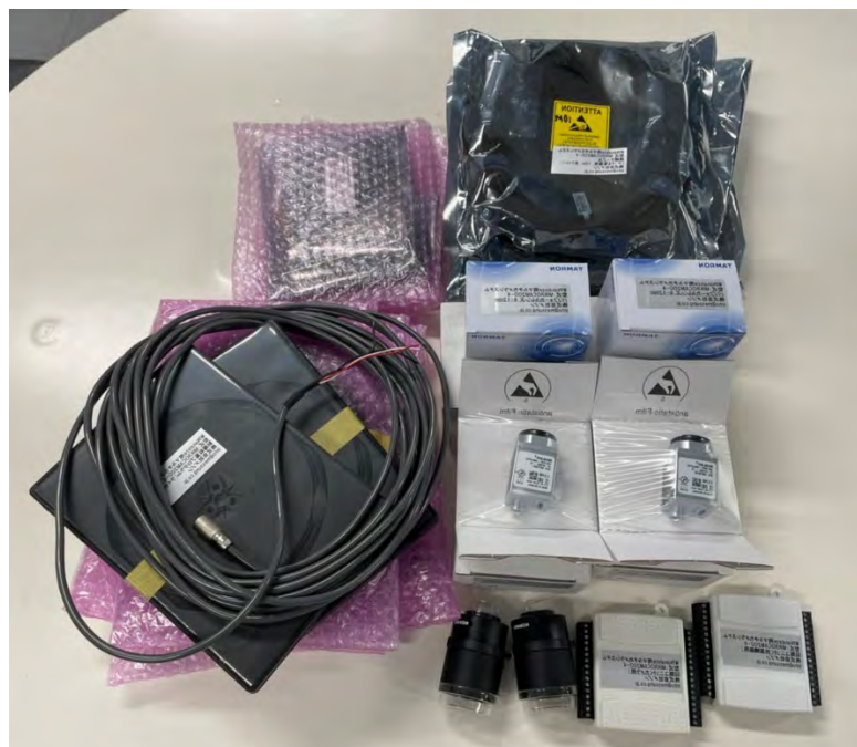
図 8: 動作解析カメラシステム(MICROCAM200-4)。4 台のカメラを用いて被験者の動作を 3 次元的に捉える。
