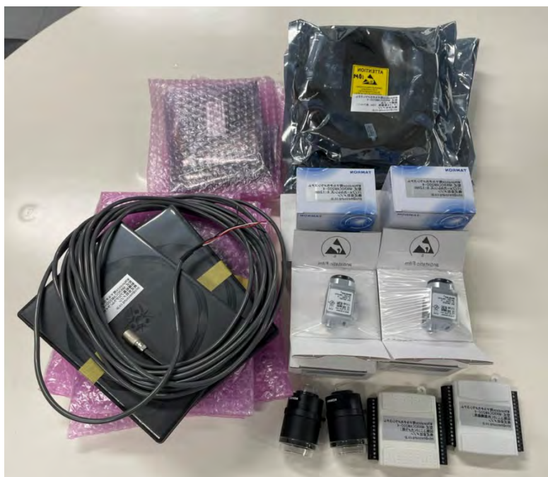
図 9: 動作解析カメラシステム(MICROCAM200-4)。4 台のカメラを用いて被験者の動作を 3 次元的に捉える。
