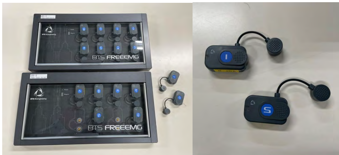
図 7: 筋電計 (FreeEMG1000) 装置。ワイヤレスで筋電図を測定することができ、被験者への負担が少ない。
