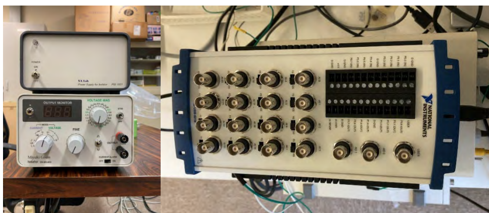
図 13: 左図はアイソレーター(下)と電源供給装置(上)。右図はデジタル-アナログ変換器。
