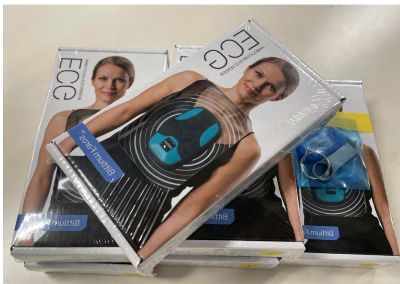
図 11: 心電計 (Bittium Faros180)。 小型の心電計で 24 時間装着可能で、最大 2 週間連続で心電図を記録することができる。
