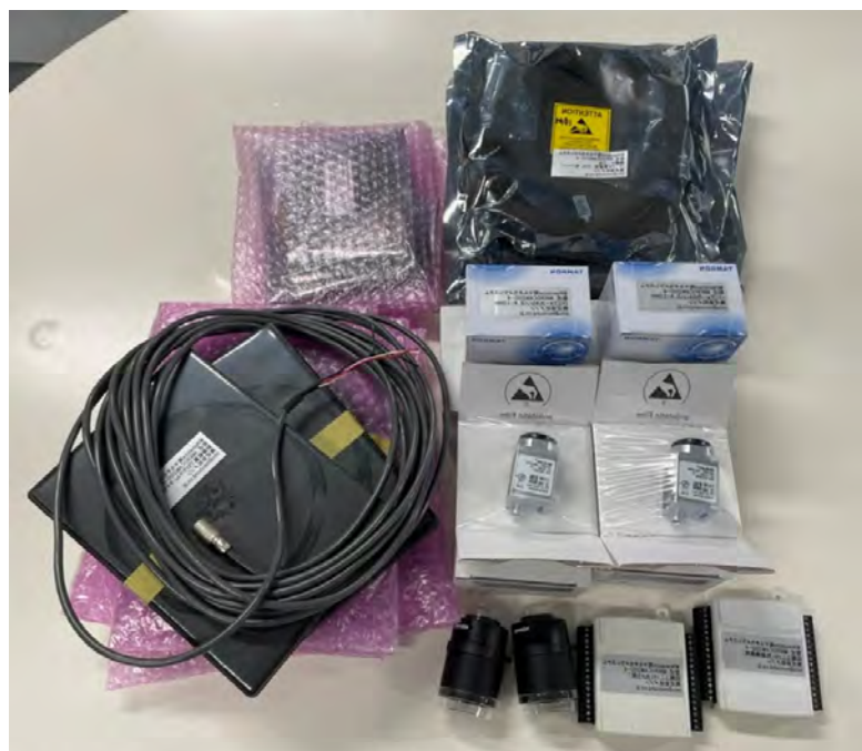
図 6: 動作解析カメラシステム (MICROCAM200-4)。4 台のカメラを用いて被験者の動作を 3 次元的に捉える。
