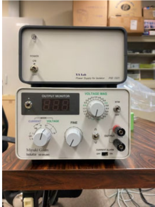
図 11： アイソレーター（下）と電源供給装置（上）
