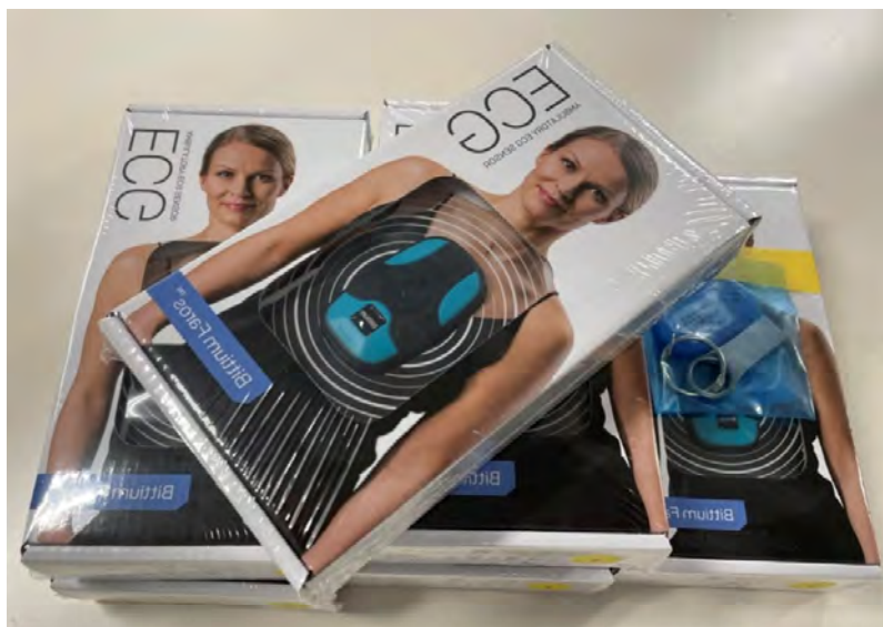
図 7: 心電計(Bittium Faros180)。小型の心電計で 24 時間装着可能で、最大 2 週間連続で心電図を記録することができる。
