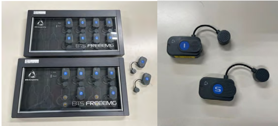
図 5: 筋電計 (FreeEMG1000) 装置。ワイヤレスで筋電図を測定することができ、被験者への負担が少ない。
