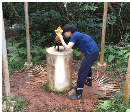
変化観測の補正のために定期的に行う絶対観測（父島）
