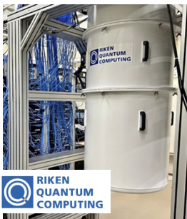
国産超伝導量子コンピュータ 「穀-II（エイツー）」
