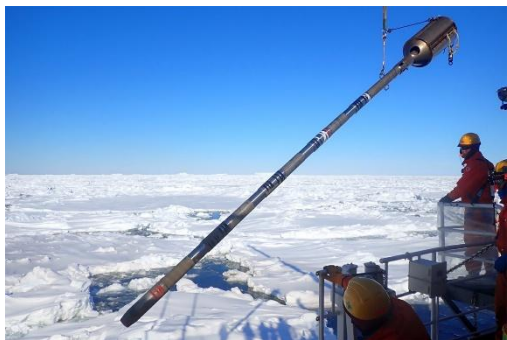
第61次南極地域観測隊（2019-2020年）における「しらせ」からの海底堆積物コア採取の様子。筒型装置（コアラー）を海底に垂直に突き刺した後引き上げ、堆積物を採取する。
