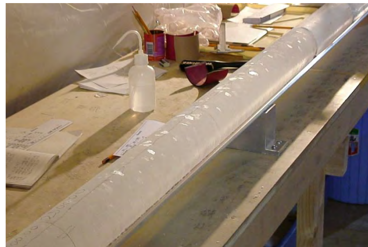
ドームふじ氷床コア深部（深度2,500m付近）のアイスコアの写真。直径94mmの円柱状の氷の表面に、光の反射の異なる多数の領域がパッチ状に浮き出ている。この不均一な反射パターンは、多数の異なる配列方位をもつ結晶粒からなる「多結晶構造」を反映している。
