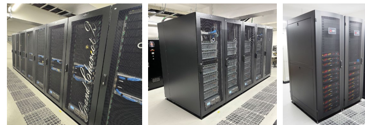
運用中のスーパーコンピュータ Grand Chariot 2 左:CPUノード群 中:GPUノード群 右:オールSSDストレージ
