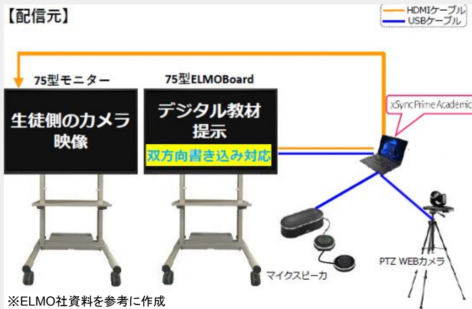
機材の接続図（配信側）
