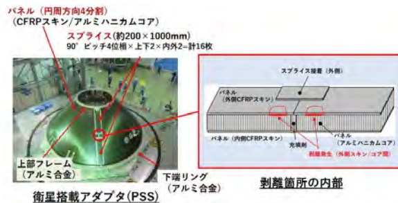
図 2-2 衛星搭載アダプタ (PSS) とスキンの剥離
