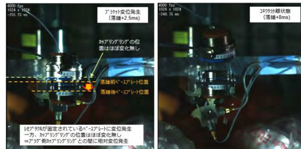
衝撃試験によるコネクタ分離
