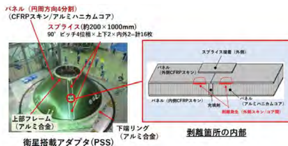
図 2-2 衛星搭載アダプタ (PSS) とスキンの剥離
