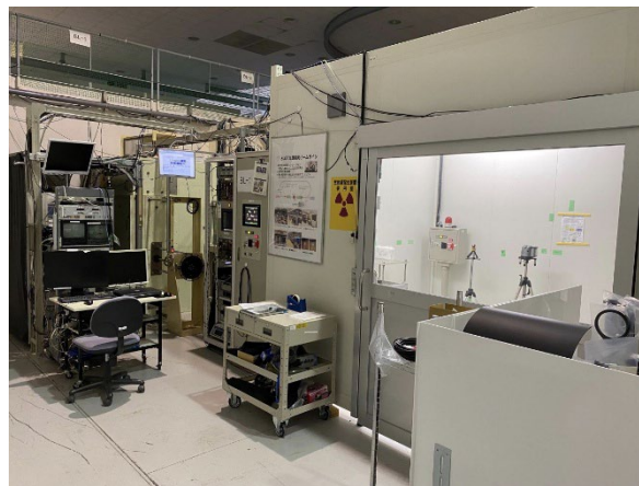
レーザーコンプトンガンマ線源 0.5 - 76 MeVの ガンマ線発生可能
