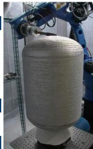
WAAM積層造形設備 (左) とWAAM技術で造形した直径40cmの小型タンク (右)
