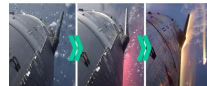
米国SpaceX Starshipの大気圏再突入の様子(熱による損傷)
