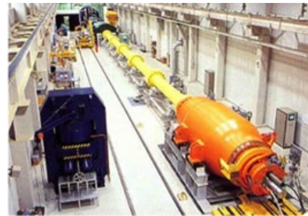
高温衝撃風洞(HIEST) 世界最大の衝撃風洞。再突入環境を模擬した試験や水素ガスを燃料とした複合サイクルエンジンやスクラムジェットエンジンの試験が可能
