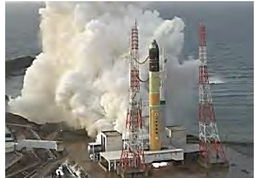
CFTでのエンジン燃焼中の状況(2025年7月24日)
