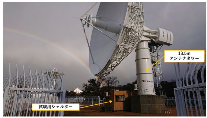
図4 適合性試験における試験用シェルター設置
