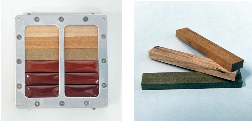
図 2-1 木材暴露試験体
