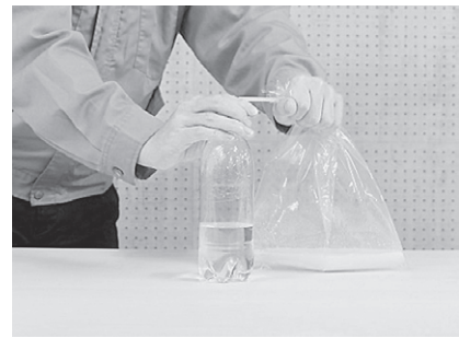
図 3 発生した二酸化炭素をペットボトルに導いているところ
