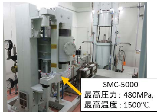
図1 実験に使用した産総研の内熱式ガス圧装置。
