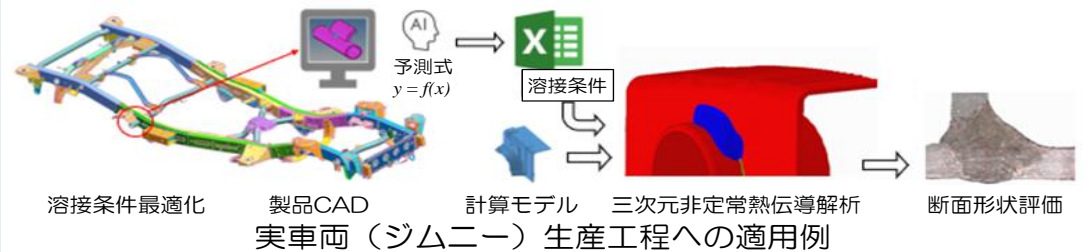
数理最適化アルゴリズムと溶接条件決定評価マップ
