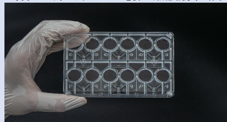
写真2 オンチップポンプ型多臓器MPSデバイスで使用するバイオステラ™プレート
