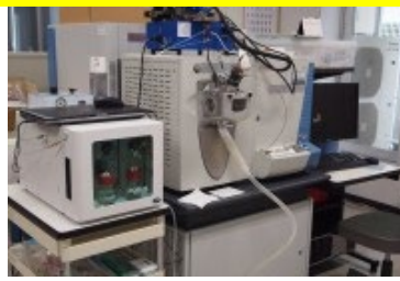
ESI (or DART)-LIT-Orbitrap型 質量分析装置
