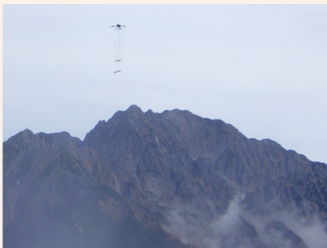
写真 焼岳で実施したドローンを用いた空中磁気測量の様子
