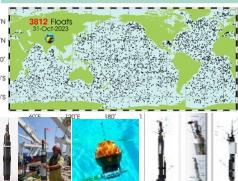
全球海洋の深度2000mまでの水温・塩分を常時計測する現行のArgoフロート観測網を、海底まで、かつ、生物地球化学変数の計測にまで拡張する統合全球海洋観測システムOneArgoを構築する。海洋全層における気候変動シグナルの検出や、海洋酸性化・貧酸素化の実態把握と生態系の応答の解明等により、海洋融合研究を推進する。
