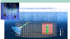
南極点直下に設置したIceCube検出器を世界15か国の連携により高度化し、世界最大のニュートリノ観測装置により高エネルギー宇宙ニュートリノの高感度観測を行う。電波からガンマ線まで分布する電磁波及び重力波との統合観測によるマルチセンジャー天文学を展開し、宇宙線の統合的理義、遠方宇宙や天体内部の探求に貢献する。
