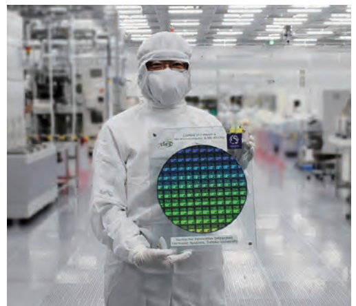
東北大学の先端施設（クリーンルーム）で半導体ウェハに作製された集積回路
