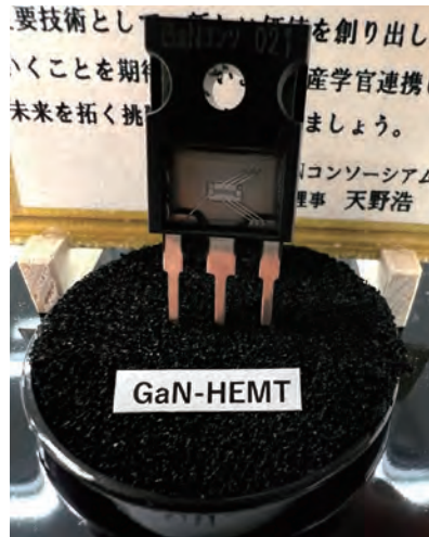
名古屋大学で開発されたGaN（窒化ガリウム）ノーマル半導体デバイス（GaN-HEMT）
