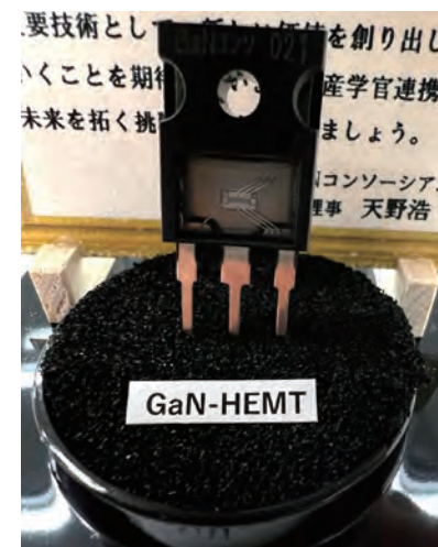
名古屋大学で開発されたGaN(窒化ガリウム)/パワー半導体デバイス(GaN-HEMT)
