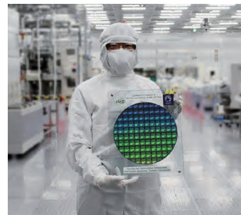
東北大学の先端施設(クリーンルーム)で半導体ウエハに作製された集積回路
