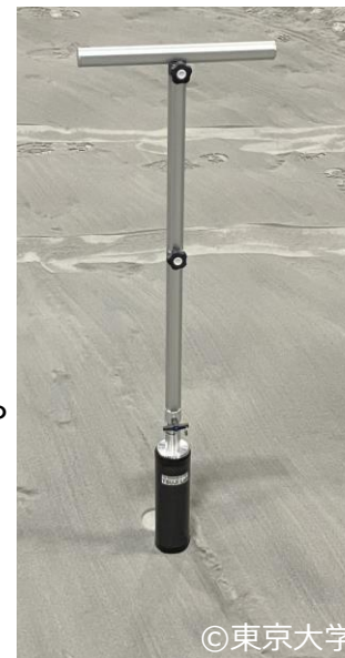
宇宙飛行士用に設計された 小型震源装置（PASS）
