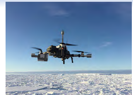
各種センサを搭載した気象ドローン
