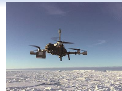
各種センサを搭載した気象ドローン
