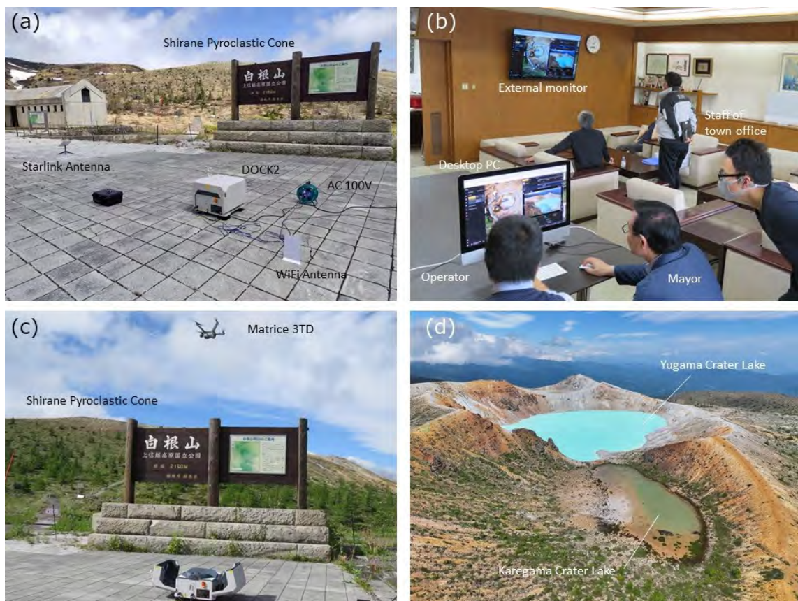
図 4．ドローンポートを用いた観測試験．草津白根山上空のドローンを草津町役場から遠隔操縦した (寺田・田村, 2025, 東京科学大学 [課題番号: TIT_01]) 。
