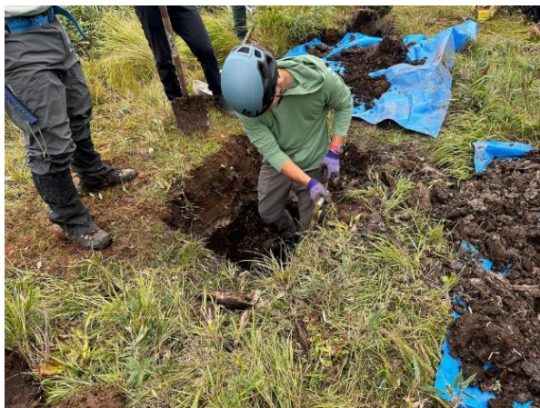
図2 ピット掘削の例 人力で穴を掘り、露頭を作成する。
