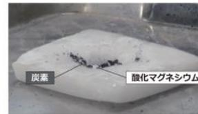
ドライアイスを使用して二酸化炭素中でマグネシウムを燃焼させる実験動画
