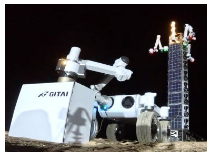
↑基地局アンテナの設置実証に成功 GITAI
