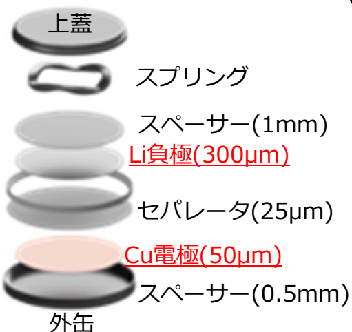
コイン電池の構造
