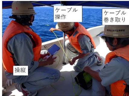
水中ドローンによる潜水調査
