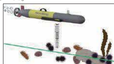
AUVを使用した沿岸漁場総合測定システム
