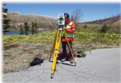
GNSS、水準儀等を用いて火山体の変形等の観測を強化
