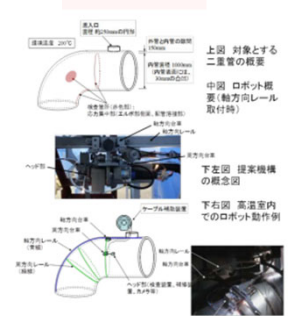
図3 ロボットを用いた遠隔操作溶接補修技術の高度化
