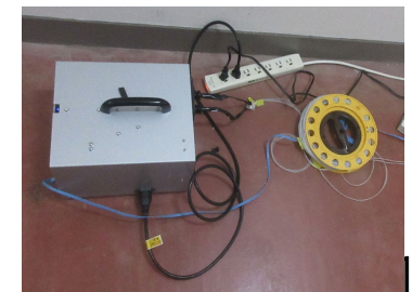
(a)開発した線量率計（初期試作機）、(b)(c)蛍光体 （ハード、ソフトとも現場（東電ニース）に合わせて自作）
