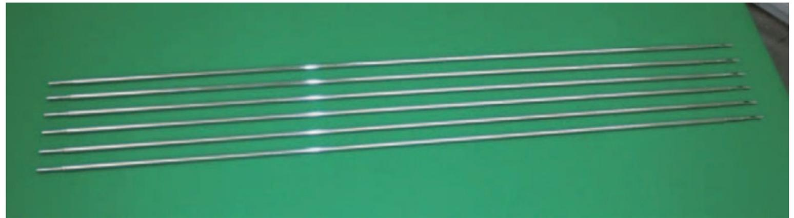
製造した金属燃料スラグ（U-20Pu-10Zr）と金属燃料ピン
