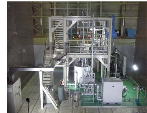
硝酸根分解の実証プラント規模試験装置
