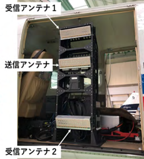
航空機に搭載したSAR装置
