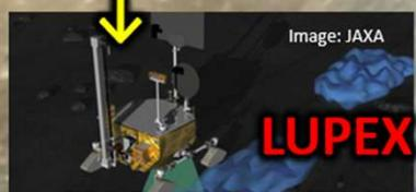
南極の着陸地点で掘削して水探索し、移動しながら誘電率調査(地中レーダ)
