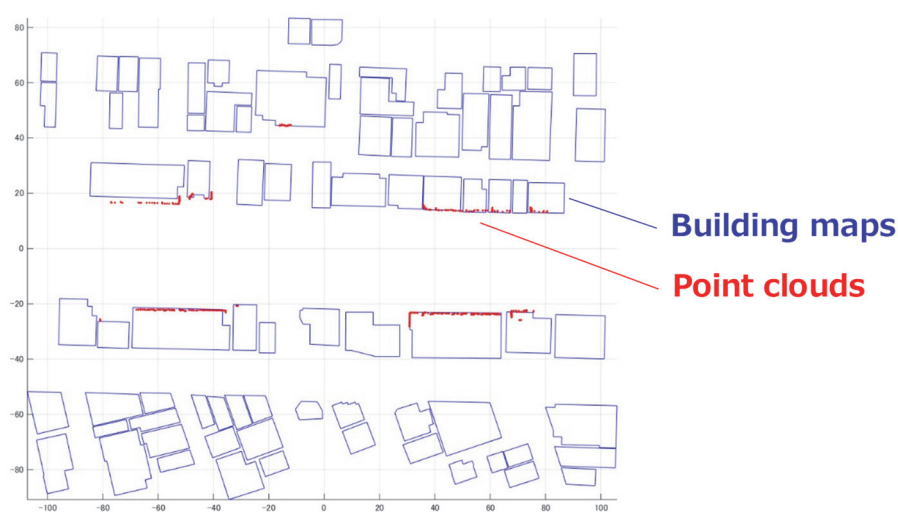
図 37. 点群(1 スキャン分)と建物データの重ね合わせ結果
