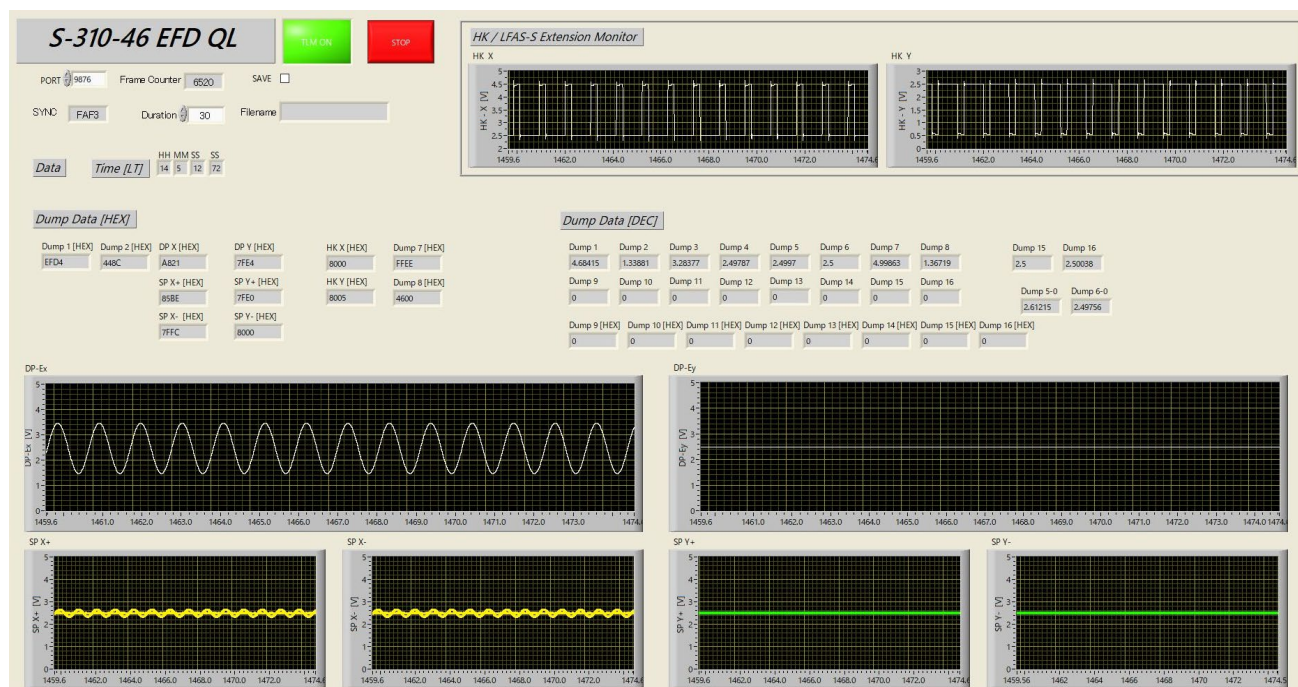
図 2.2-5 Ex+に 1Hz の正弦波を入力したときの QL 画面
