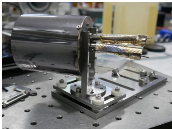
図 6-1 (a) 組み合わせ作動用の LaB<sub>6</sub>カソードジグ外観. (b) ジグにカソードを取り付けた状態の外観.
