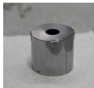
図 2-7 ヒートシールド外観
