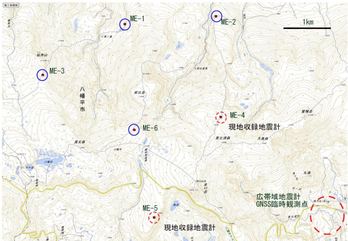
図1．八幡平で機動地震観測，広帯域地震・GNSS 観測計画．ME1～6 は熱資源調査のために設置した臨時地震観測点．このうち青丸の地点は安比地熱（株）が観測を継続．当面，赤点線丸の地点で地震機動観測を実施する．右下の赤丸の松尾鉾山跡近辺に広帯域地震・GNSS 観測点を設置予定．
