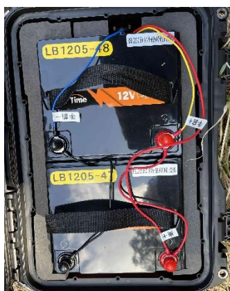
図4. タイプ1地震観測システムの記録計(左)及び補助電池(中央)を収納する防水トランク(43×33×23 cm). 左側のトランクに地震計を接続するだけで約 1.5 ヶ月間の地震観測が実施できる。補助電池を併用すると連続 4.5 ヶ月間の運用が可能になる。右図は観測システム全体の外観。緑シートの下に地震計が埋設されている。
