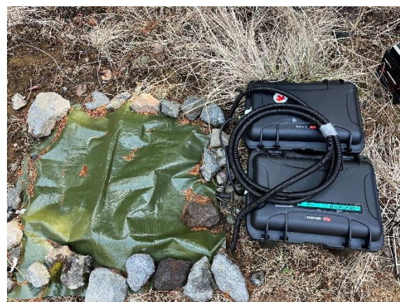
図4. タイプ1地震観測システムの記録計(左)及び補助電池(中央)を収納する防水トランク(43×33×23 cm). 左側のトランクに地震計を接続するだけで約 1.5 ヶ月間の地震観測が実施できる。補助電池を併用すると連続 4.5 ヶ月間の運用が可能になる。右図は観測システム全体の外観。緑シートの下に地震計が埋設されている。
