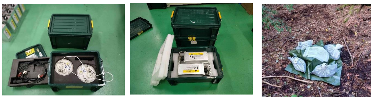
図6．タイプ2地震観測システム本体運搬用ケース（左写真）及び補助電池運搬用専用ケース（中央写真）．それぞれ2セットずつ収納できる．両者を重ねて背負子に固定し，観測点まで運搬することを，想定している．これにより1人で2観測点分を運搬できるようになった．観測点では本体と補助電池を設置し，緑色のシートを被せ，四隅を土嚢で固定する（右写真）．
