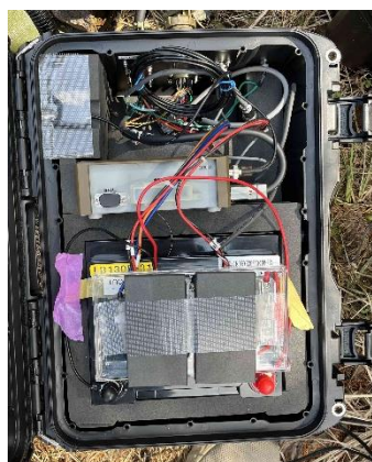
図4. タイプ1地震観測システムの記録計(左)及び補助電池(中央)を収納する防水トランク(43×33×23 cm). 左側のトランクに地震計を接続するだけで約 1.5 ヶ月間の地震観測が実施できる。補助電池を併用すると連続 4.5 ヶ月間の運用が可能になる。右図は観測システム全体の外観。緑シートの下に地震計が埋設されている。
