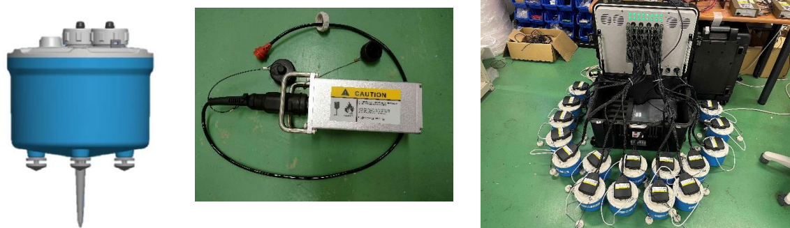
図5．タイプ2地震観測システムの地震計本体（左写真）．設置場所によっては底部にニードル付け，地面に打ち込んで利用する．記録計，GNSS 受信機，リチウムバッテリーを本体に内蔵．単体で約1ヶ月の地震観測が可能．補助電池（中央写真）を接続することで観測期間を約3ヶ月まで延長できる．動作設定，データの回収，本体にバッテリーの充電は専用の接続装置で16台を一度に操作できる．
