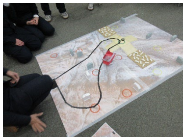
(マップ上をライントレース カーが走行する様子)
